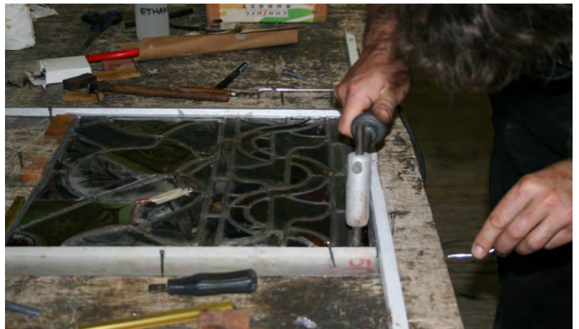
Soudure des intersections
